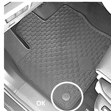
Autokoberce řidiče Správně umístěný a upevněný
